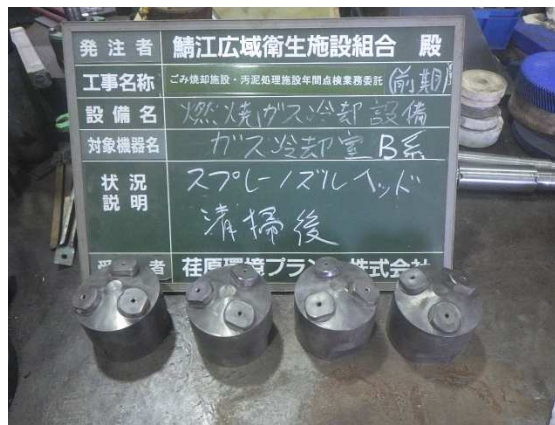
【ガス冷却室スプレーノズル整備後】
